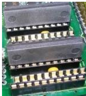
Fig :ZigZag IC & Socket
